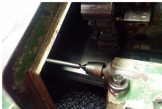
ภาพประกอบ 1 การตัดเฉือนชิ้นงานด้วยเครื่องกลึงอัตโนมัติซีเอ็นซี
