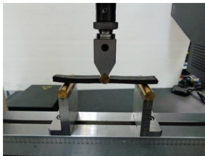
ภาพประกอบ 2 ภาพการทดสอบ Flexural (3-point)
